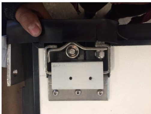
Pre ensamble de la bisagra Superior
